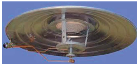
Figura 87: Criadora a gas licuado de petróleo
