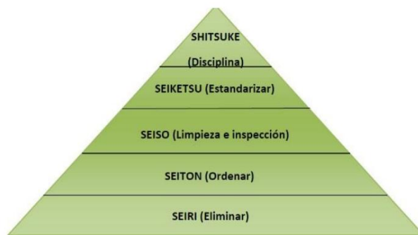
Figura 2 Pilares del 5s
